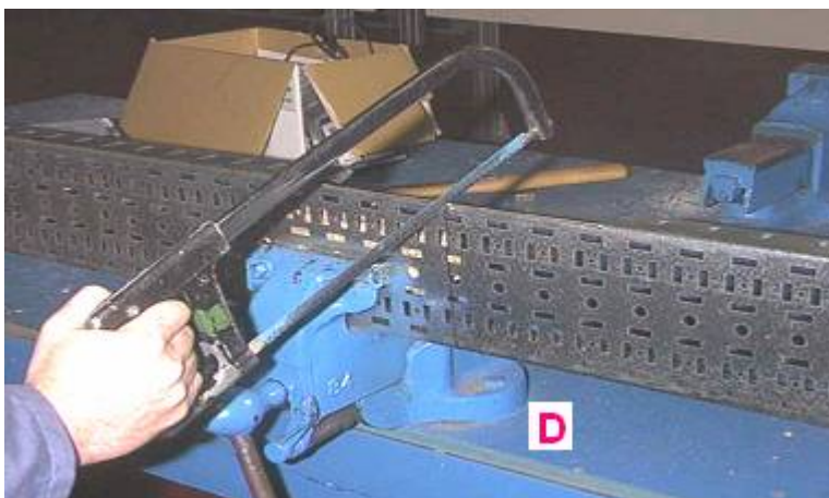
Figure 100: Construction of a flat 90° bend (D)
