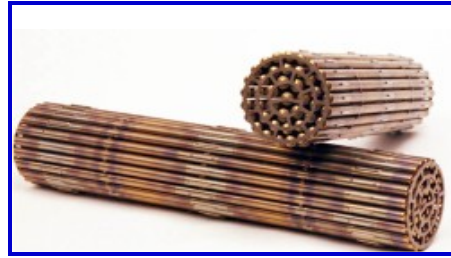
شكل 7-ب: صورة حزم وقود مفاعل كاندو [5]. (طول حزمة الوقود النووي 50 سم وقطرها 10 سم).
