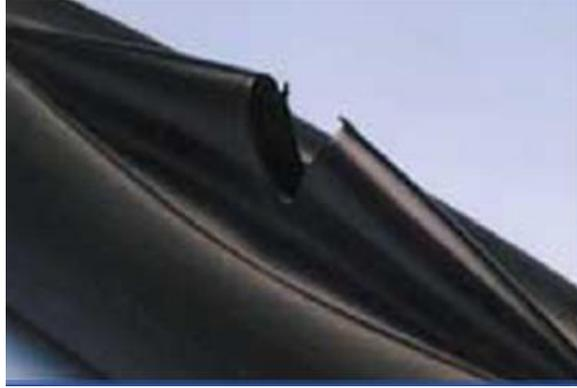
الشكل (24-4) انفجار الأنبوب في تجربة الضغط الهيدروستاتيكي
