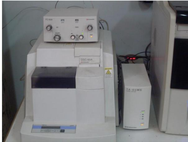
الشكل (4-17) جهاز تجربة الشبات الحراري
