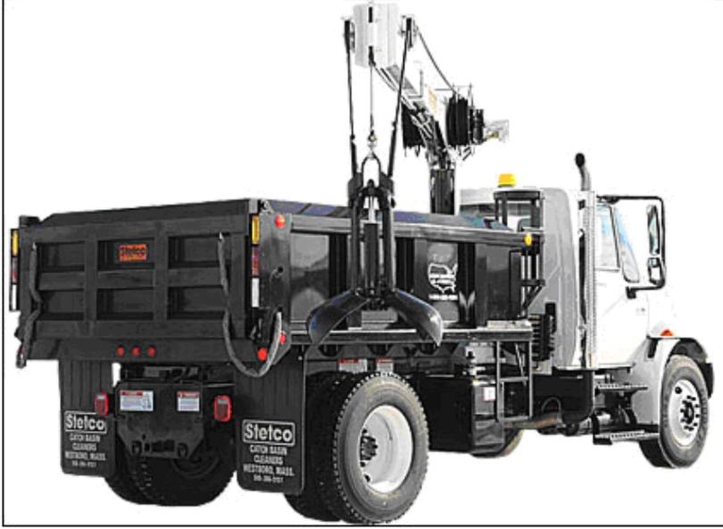
الشكل (9-36) السيارة الكباش
