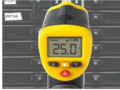
ميزان الحرارة بالأشعة تحت الحمراء، قياس درجة الحرارة في نقطة واحدة
