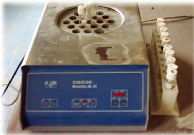
الشكل (م - 2) الحاضنة المستعملة لقياس COD
