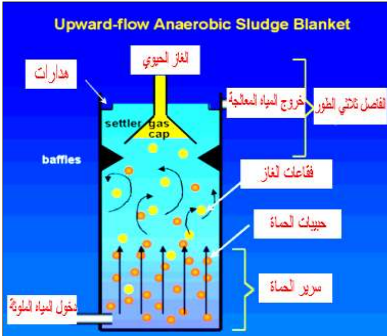
الشكل (14) مفاعل UASB
