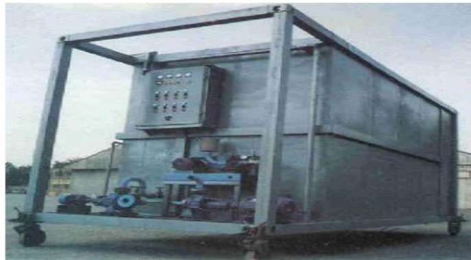
إحدى حاويات محطة تنقية مياه شرب نقالية صغيرة
