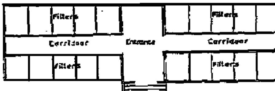
شكل رقم (٥-٩) ترتيب وحدات الترشيح في مبنى المرشحات
