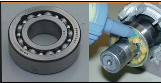
شكل رقم ( ٤-٦ ) يوضح رولمان البلي وطريقة وضع الشحم عليه
