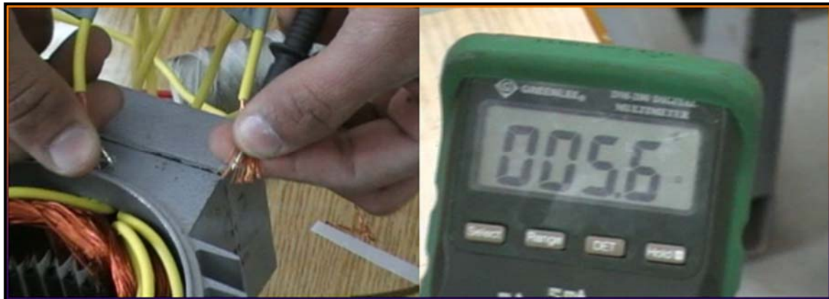
شكل رقم ( ٤-١٥ ) يوضح طريقة اختبار الدائرة المفتوحة في المحرك
