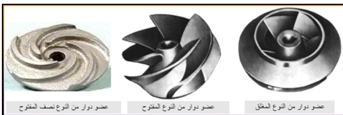
شكل رقم ( ٤-٩ ) يوضح الأشكال المختلفة للدافعة ( العضو الدوار )
