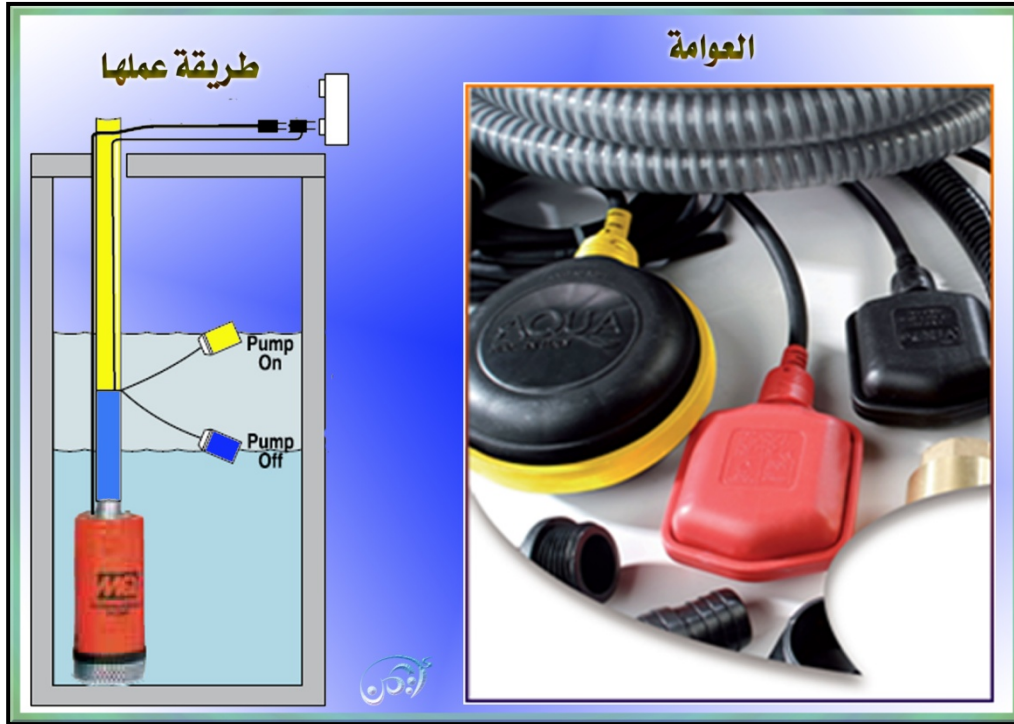
شكل رقم ( ٤-١٢ ) يوضح العوامة وطريقة عملها
