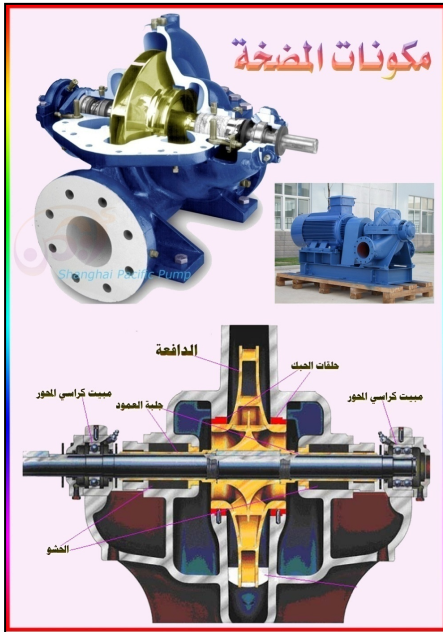
شكل ( ٦ - ٢١ ) يوضح التركيب الداخلي لمضخة ثنائية
