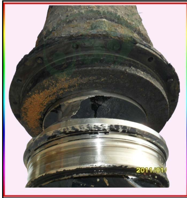
شكل ( ٦ - ١٨ ) يوضح الدافعة ( العضو الدوار للمضخة )
