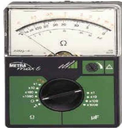
يستخدم هذا الجهاز لقياس مقاومة الاحمال الكهربائية وللتأكد من صلاحية هذه الاحمال، يوصل هذا الجهاز مع الاحمال المراد قياس مقاومتها على التوازي مع مرعاه عدم وجود سريان للتيار الكهربائي أي ان تكون الدارة مفتوحة.
