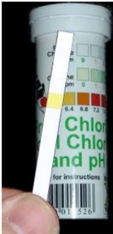
ويقاس (تركيز أيونات الهيدروجين) في الماء، بجهاز قياس الأس الهيدروجيني (pH meter)، فالمواد المتعادلة الحموضة، مثل الماء النقي، قيمة الأس الهيدروجيني لها = ٧ أما الأحماض، فإن قيمة الأس الهيدروجيني لها تراوح بين صفر و ٦,٩، أما المواد القاعدية (القلوية)، فإن قيمة الأس الهيدروجيني لها تراوح بين ٧ و ١٤.
