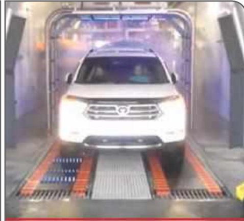
الشكل (a, 1-2-27) الغسيل بالسير conveyor
