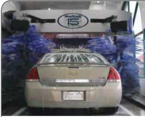
الشكل (b,1-2-27) الغسيل الآلي في النفق in-bay automatic
