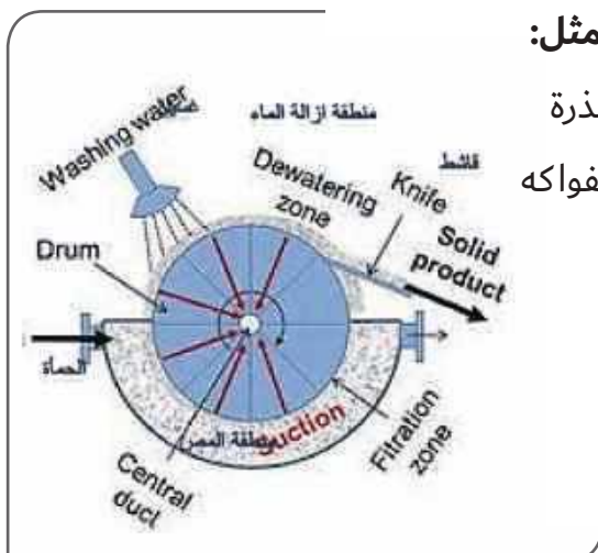
الشكل (2-4-2-1-18) توضيح لعمل المرشح الإنفراغي المستمر
