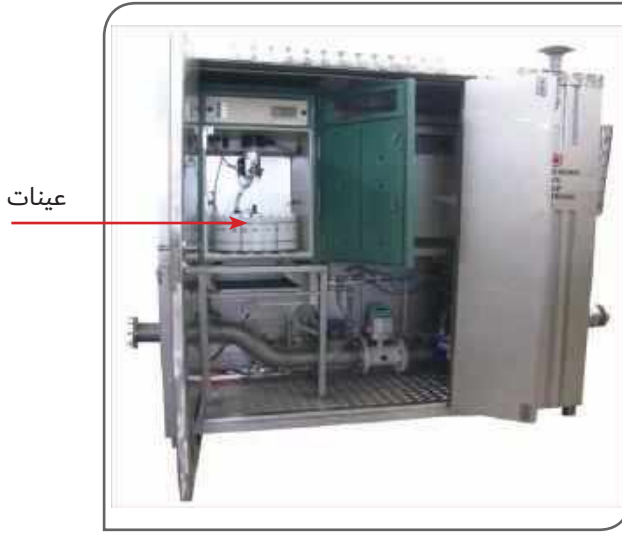
الشكل (2-5-2) يوضح نموذج لآلة اخذ العينات اليأ
