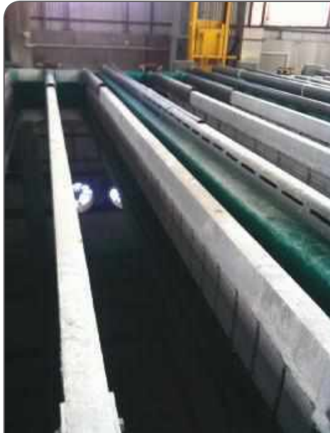
الشكل (1-1-23) الأكسدة المصعدية للألمنيوم Anodizing (معمل اليت في راس الخيمة)
