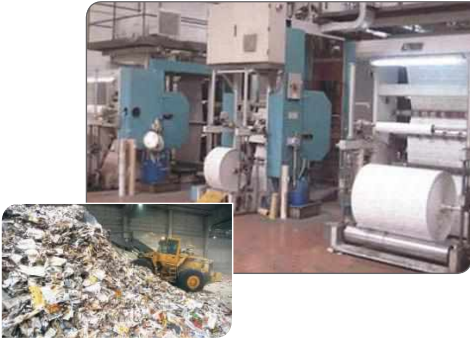
الشكل (1-1-4-24) معمل ارايبيكو. مرحلة لف الورق - صورة لنفايات الورق قبل مباشرة التصنيع
