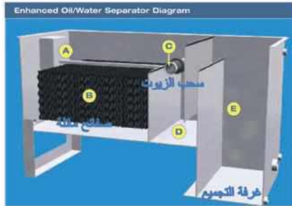
الشكل (2-1-5-27) نموذج فاصل زيوت بالراحة مع الصفائح المائية
