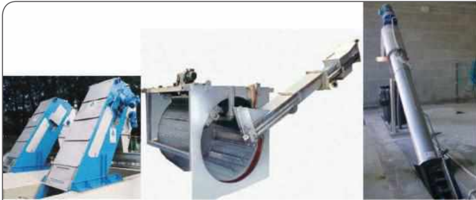
الشكل (1-3-20) من أنواع المصافي الآلية المستعملة في الدباغات
