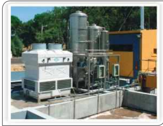
الشكل (1-1-2-17-3-8) المبخر بالأنابيب - التدفق من الاعلى للأسفل
