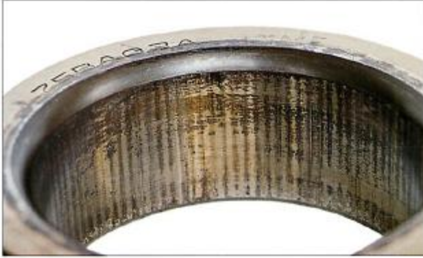
تشوه فى المجرى الداخلية لكرسى زاوى نتيجة لزيادة نتيجة لضعف سماح الشحط على العمود
