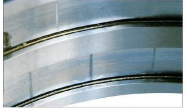
تشوه فى المجرى الخارجية لكرسى اسطوانى فى سماح الشحط للمبيت
