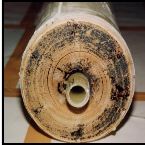
وهذه صورة للأغشية من النوع الحلزوني الملفوف Spiral wound أصيب بالبيوفولنج:
