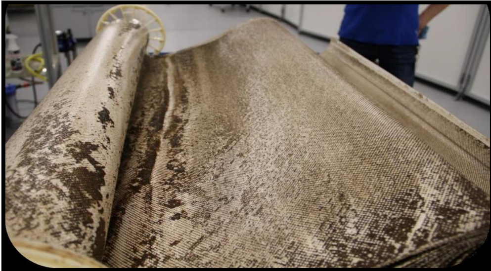
وهذه صورة للأغشية من النوع الحلزوني الملفوف Spiral wound أصيب بالبيوفولنج:
