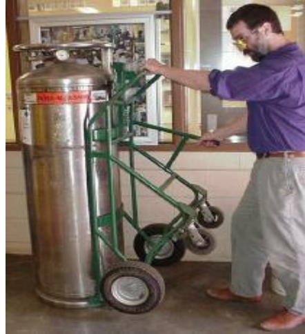
شكل رقم (١٤-٣) تحريك ونقل اسطوانات الغاز المضغوط على عربة خاصة
