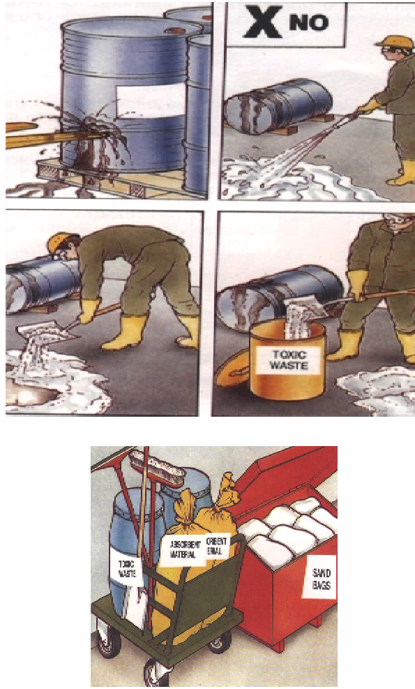
شكل رقم (١٤-٨) طريقة التعامل مع الإنسكابات والأدوات اللازمة
