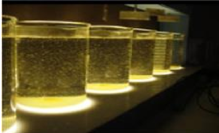
شكل رقم (٦-١٤) حجم وشكل الندف المتكونة نتيجة اضافة الشبة
