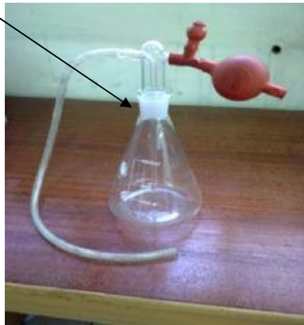
شكل رقم (٦-١٥) كيفية سحب الماء من الجزء العلوى
