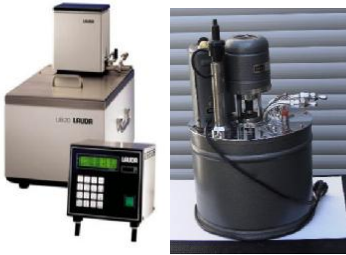
شكل رقم (٣-١٢) جهاز التنظيم الفائق لحرارة المياه
