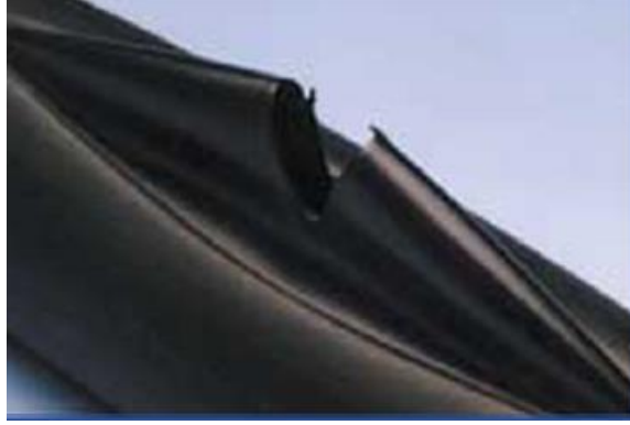
الشكل (24-4) انفجار الأنبوب في تجربة الضغط الهيدروستاتيكي
