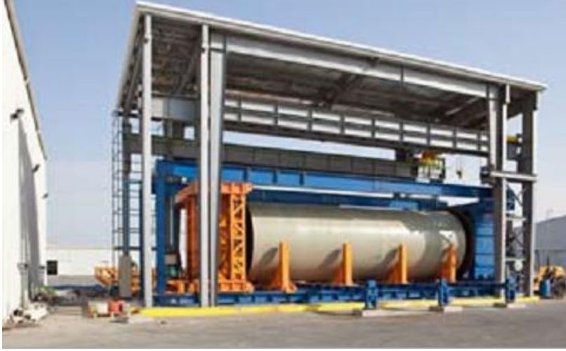
الشكل (4-12) تطبيق تجربة الضغط الهيدروستاتيكي
