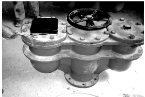
شكل رقم (١١-٦١) صمام هواء ذو الكرتين
