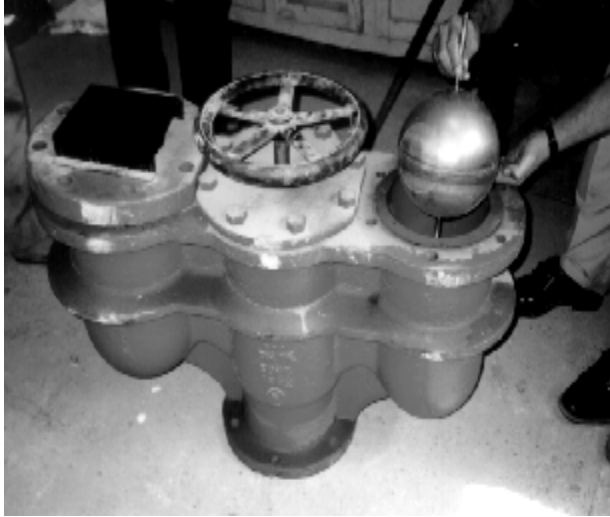
شكل رقم (١٢ - ٣٤) محبس الهواء ذو الكرة والكارتين
