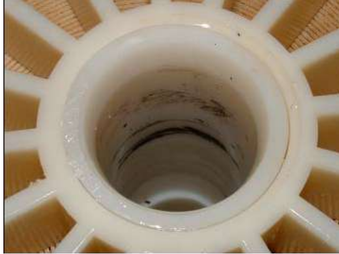
شكل ( 11 ) : صورة تبين كساء الحلقة الدائرية من داخل أنبوب الماء الناتج و ذلك بسبب التزيت غير الكافي لمانع التسرب المنزلق
