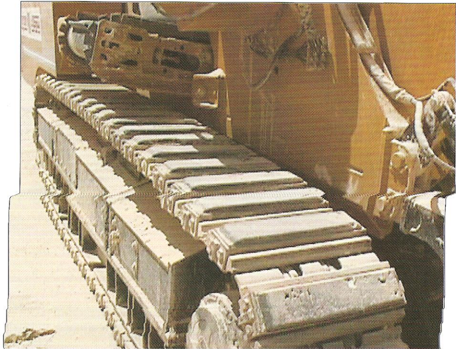
الشكل رقم ٣-٢. إضافة قطع مطاطية لسلاسل المعدات لحماية سطح الطريق
