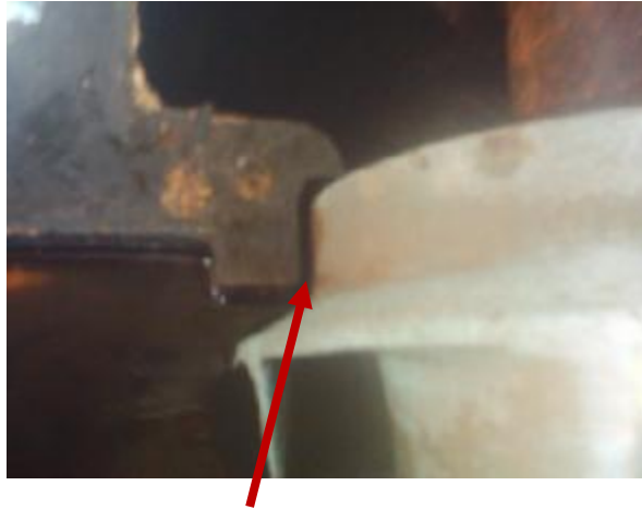
صورة رقم (٢-١٤) الخلوص الزائد بين المروحة وجسم الطلمبة
