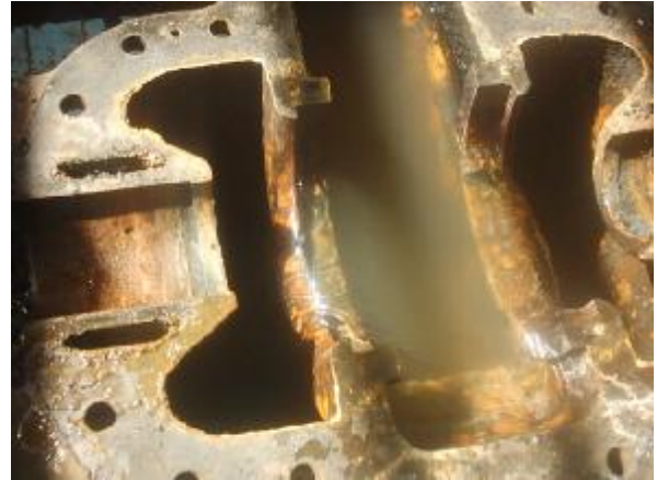
صورة رقم (١-١٤) النصف السفلي للطلمبة ويظهر تسرب المياه
