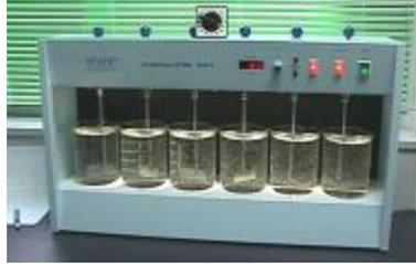
جهاز اختبار المخبار
