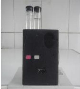
جهاز قياس الكلور المتبقى
