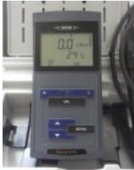
جهاز قياس التوصيل
