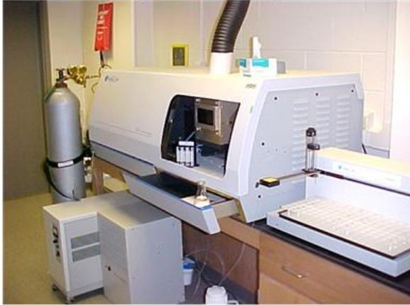
تعتمد فكرة عمل الجهاز على نفس فكرة قياس طيف الانبعاث في فوتومتر اللهب غير أن اللهب المستخدم في هذه الحالة هو بلازما درجة حرارتها تصل إلى ٦٠٠٠ درجة مئوية. وتتكون البلازما من تأين الأرجون.
