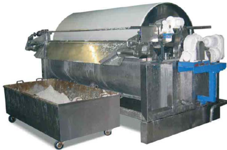
Figure 7. Vacuum filter for dewatering (Técnicas de Filtración, S.A. TEFISA).
