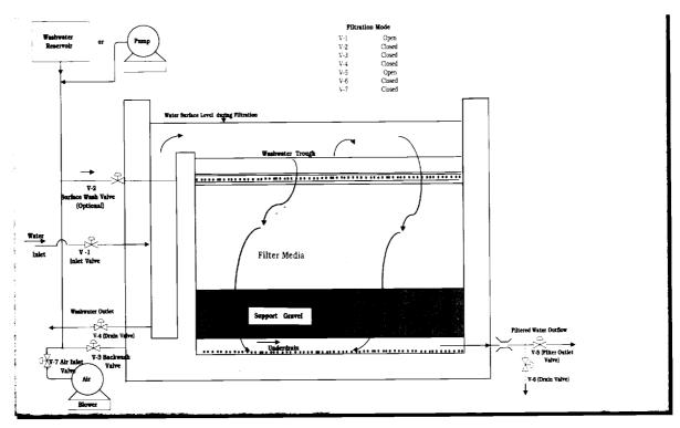
FIGURE 12: FILTRATION MODE OF OPERATION
