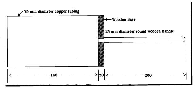
FIGURE 14: MUDBALL SAMPLER
