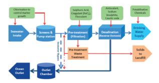
Figure 4 - RO Desalination Process (Fichtner, 2011)
