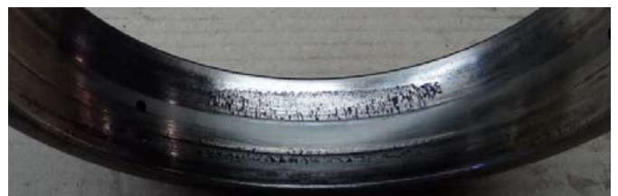
Uneven exfoliation on raceway. Specific to montajului incorect pe direcție axială sau suprasarcinii axiale.
