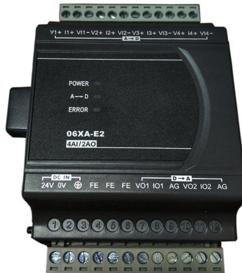
شكل (32): مدبيل أنالوج به أربع مداخل ومخرجين
