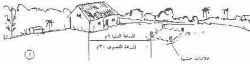
شكل 30. مراحل الحفرة (أ) موقع الحفرة (ب) القاعدة الخشبية (ج) قاعدة من الطوب او القوالب الخرسانية
