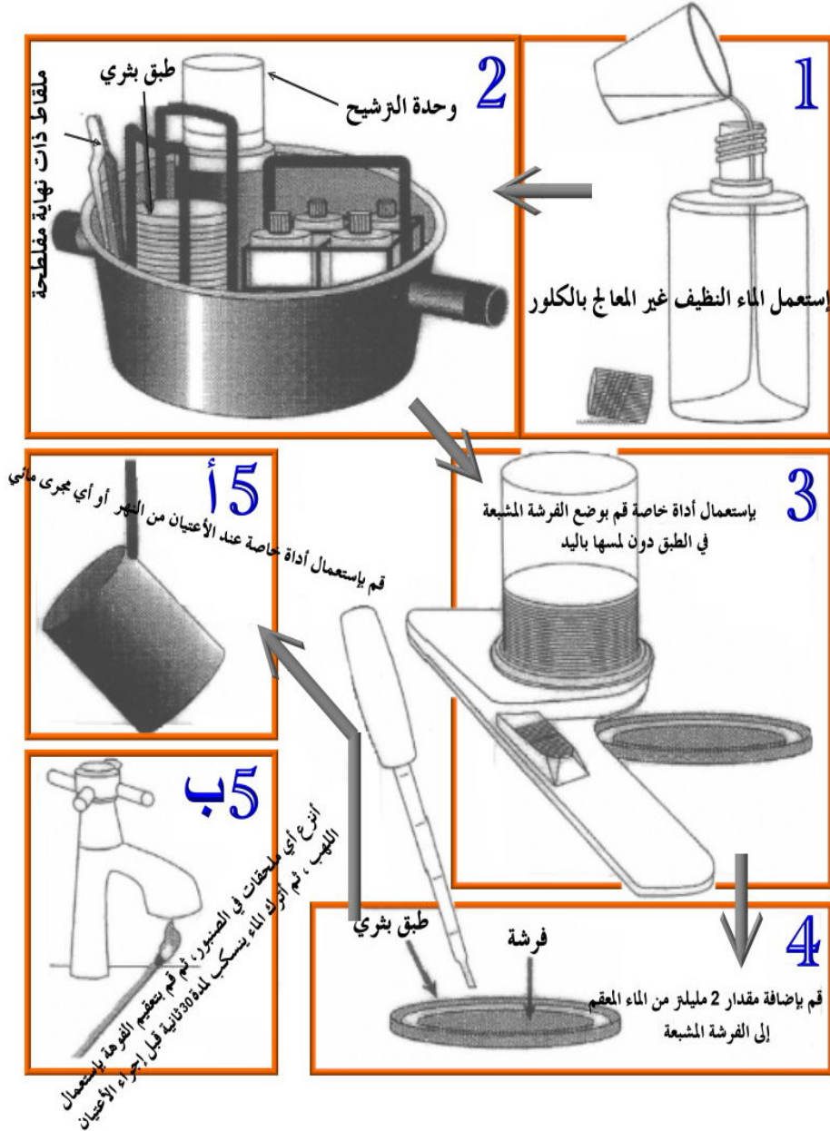
3- الخطوات العملية لاختبار الترشيح الغشائي الحقلي
