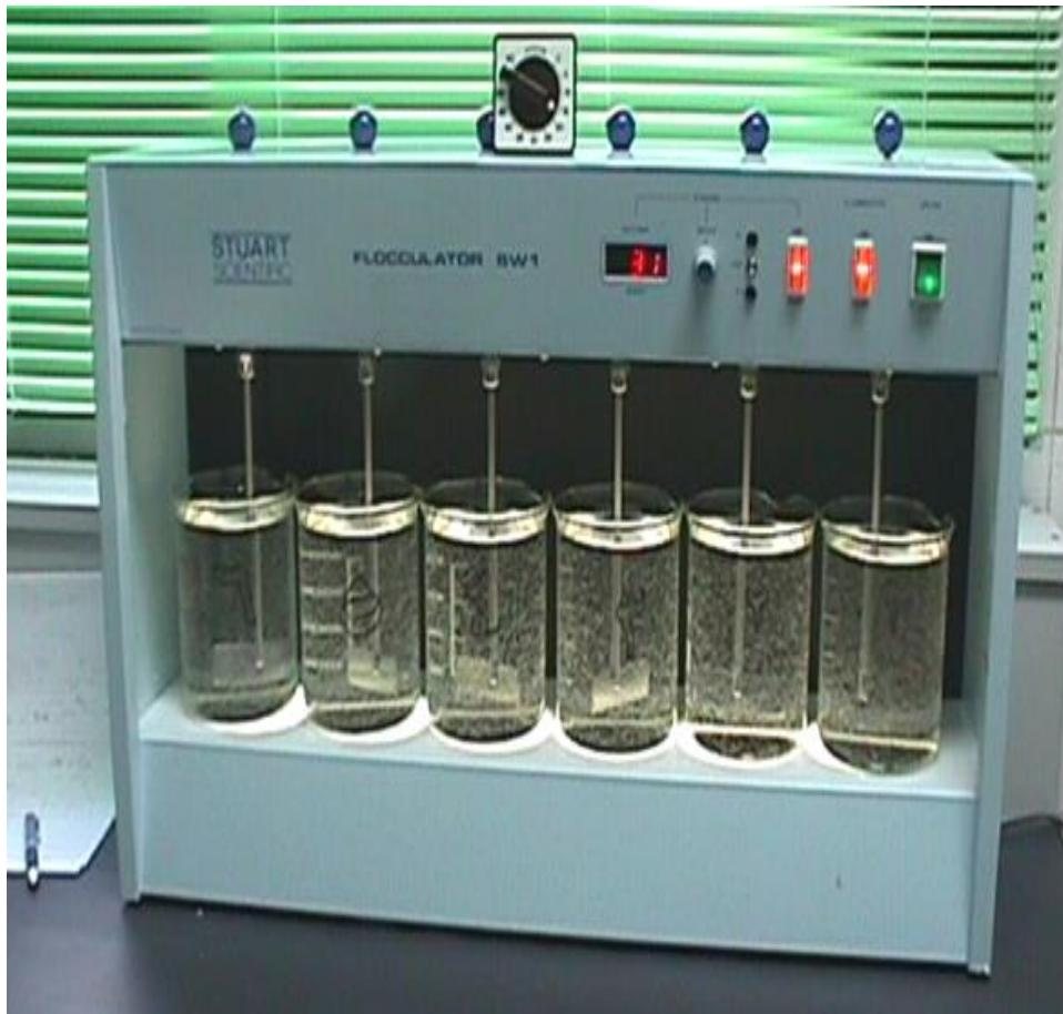
اختبار الجار تست (الكأس)
