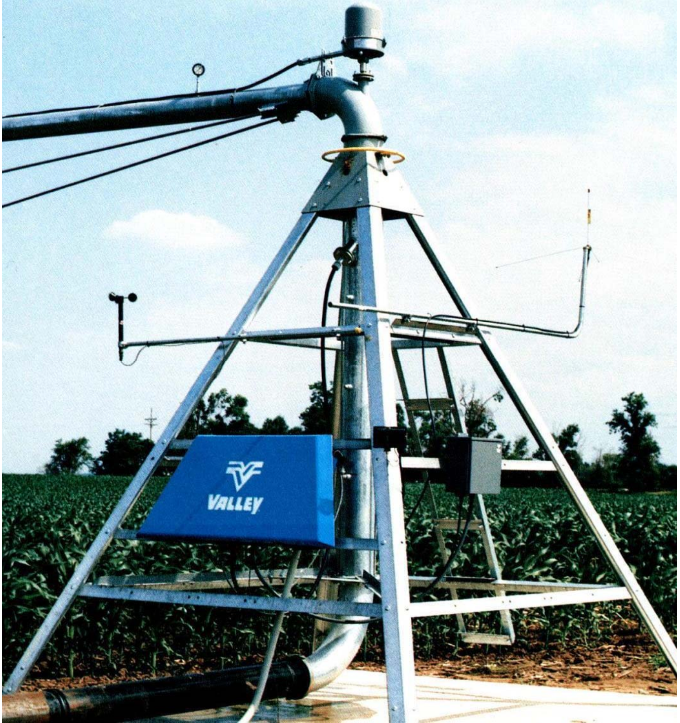
شكل (٤ - ١) قاعدة نظام الري بالرشف المحوري
