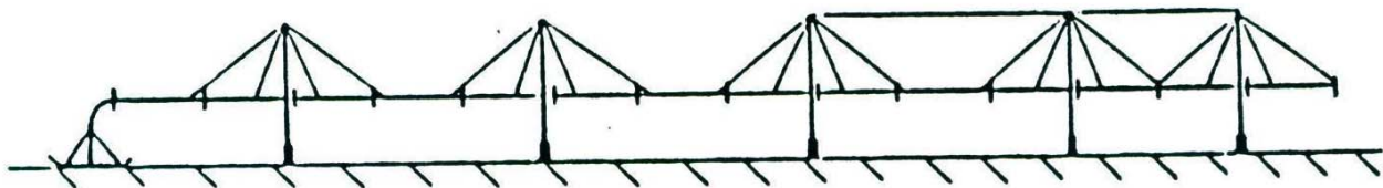
شكل (٤ - ٣) خط الرشاشات المستقيم مشدود بأسلاك ممتد من الأبراج على الخط
