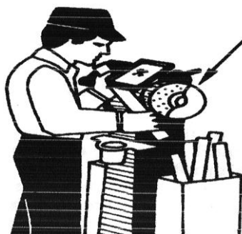
صدم اليدين بعجلة الجلف تطاير شظايا وشرز تطاير أتربة انفجار عجلة الجلف انحصار أكمام القميص في الماكينة
