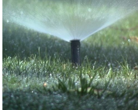
صورة رقم (٩) رشاش رذاذي (Sprayer)
