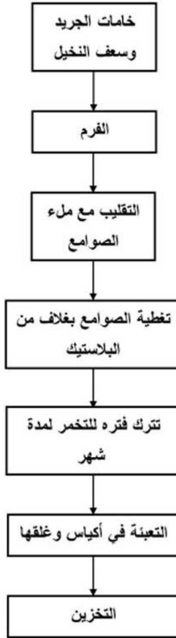
شكل يوضح الرسم التخطيطي لخطوات تصنيع العلف الحيواني من مخلفات النخيل.
