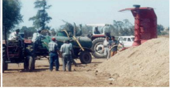
تقليب الكومة السمادية باستخدام ماكينة التقليب
