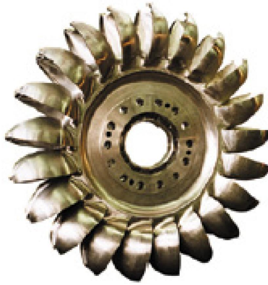
الشكل (10.6) الجزء الدوار في توربين بلتون
