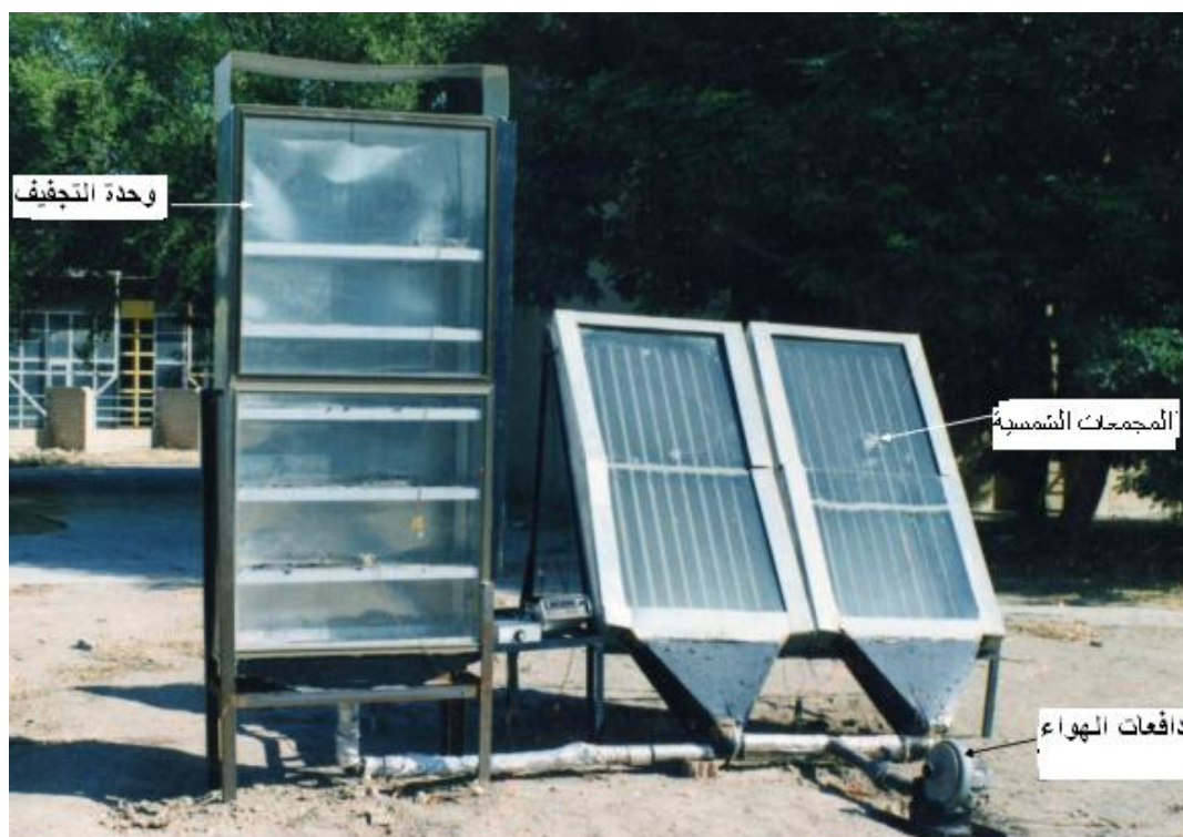
الشكل (22.4) مجفف شمسي لتجفيف المحاصيل الزراعية في مركز بحوث الطاقة العراقي.
