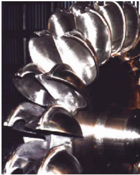
الشكل (10.6) الجزء الدوار في توربين بلتون
