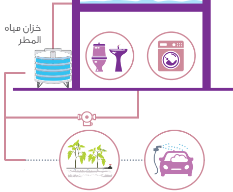
الشكل ٣٢: خزان تجميع مياه الأمطار متصل بشبكة المياه.
