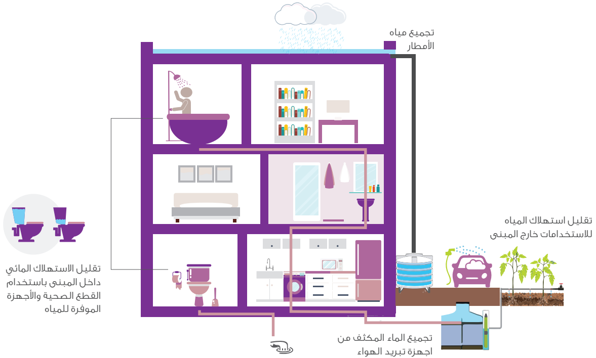
الشكل ٢٩: تدابير تقليل استهلاك المياه وإعادة استخدامها وتعويضها لتحقيق المبنى المتعادل مائياً.
