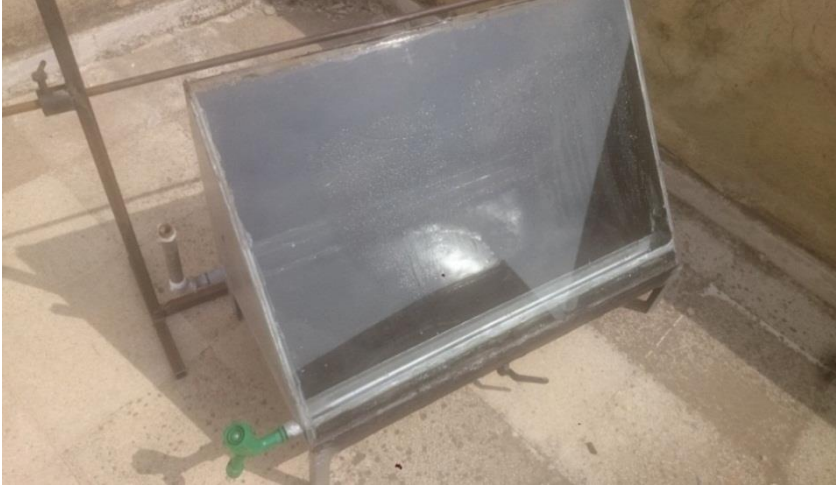
الشكل 1 : صورة جهاز التقطير الشمسي وقاعدة تثبيت المرآة المكثفة للأشعة الشمسية. ويبين الشكل (2) مكونات الجهاز وأبعاده والمرآة وحركة جريان المياه فيه.
