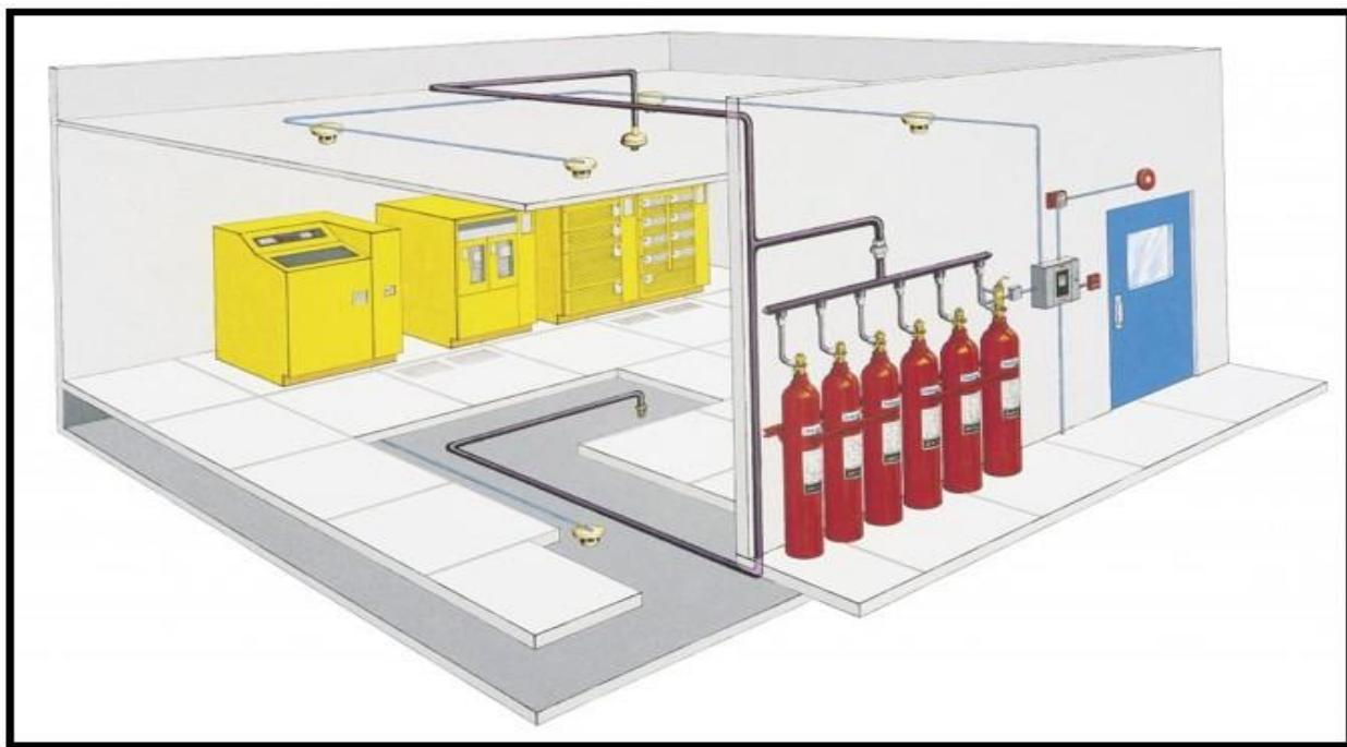
تقوم البرمجة الخاصة بلوحة الكونترول الخاصة بالنظام panel release control بإطلاق الأجهزة (as solenoids, actuators, etc.) والمتعلقة بمجموعة من الأسطوانات التي تحتوي على الغاز وذلك عند تنشيط أجهزة الإنذار من خلال جهاز الاستشعار الدخان الالكترونية smoke detectors حيث تقوم بتنشيط أجهزة التحكم وتحرير انطلاق الغاز من الأسطوانة وتغريغ غاز الإطفاء.
