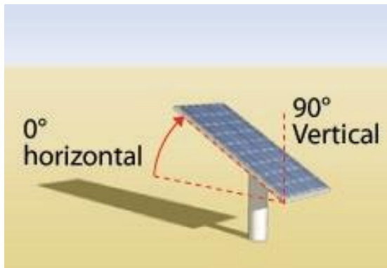
Inclination (tilt) of a PV module
