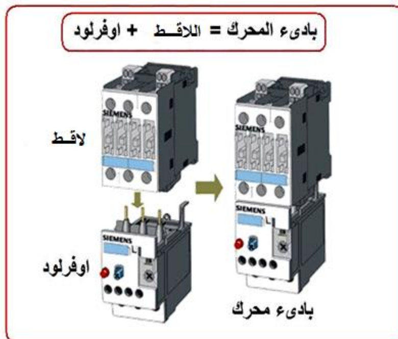
شكل (25.11) ربط اللاقط مع الأوفرلود لتكوين بادئ المحرك (الستارتير)
