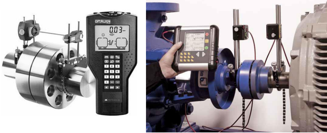
شكل (24.1) تنظيم الاستقامة للمضخة باستخدام تقنية الليزر
