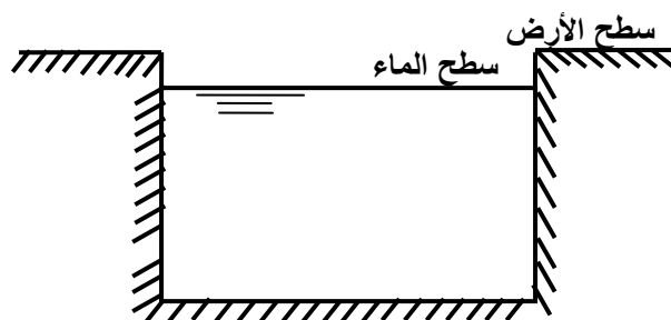
شكل (2.1): مجرى مائي مفتوح ذو مقطع مستطيل
