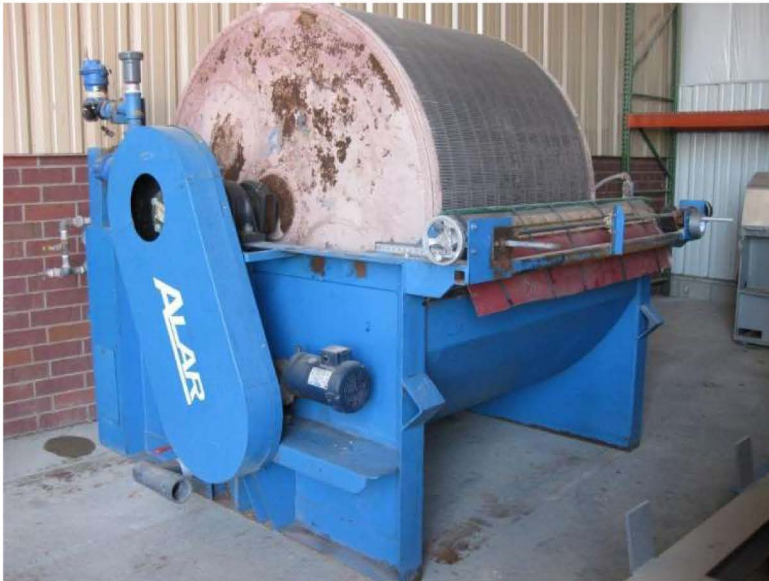
الشكل (5-7): صورة تبين وحدة الترشيح بالانفراغ لنزع رطوبة الحمأة
