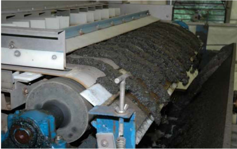
الشكل (5-10): صورة واقعية للنابذ و تظهر عليه الحمأة
