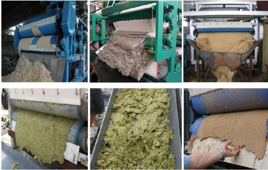
الشكل (5-12) : يظهر الحمأة الناتجة عن المكبس المرشح ذو الحزام Belt press
