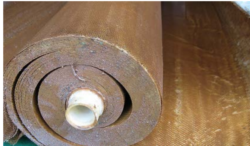
Particle (Silt) Foulant
