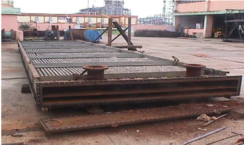
Air Fin Fan Cooler
