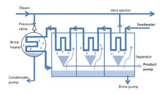
Figure 3 - MSF Desalination Process (Fichtner, 2011)
