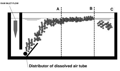
Figure 7.- Rectangular flotation chamber (CEPIS, 1992).
