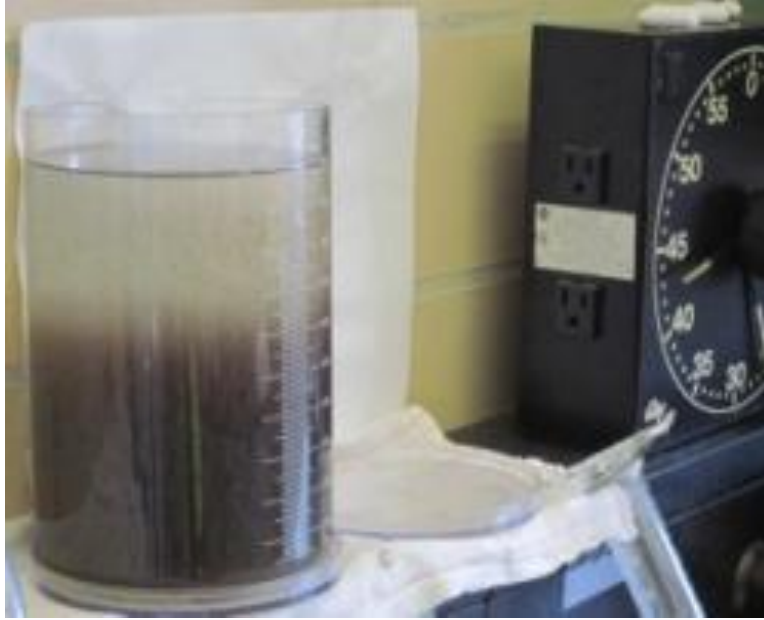
شكل رقم (٥ - ١٣) يوضح بطيء ترسيب الحمأة
