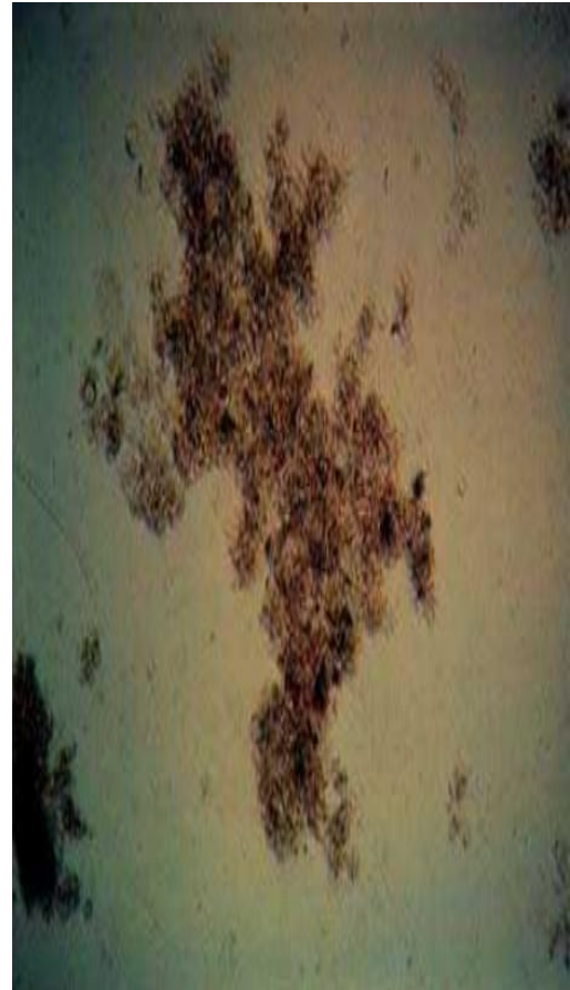
شكل رقم (٤ - ٦) تكون حمأة منشطه سريعه الترسيب
