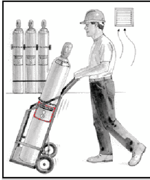
شكل رقم (٤-٣) تحريك ونقل اسطوانات الغاز المضغوط على عربة خاصة
