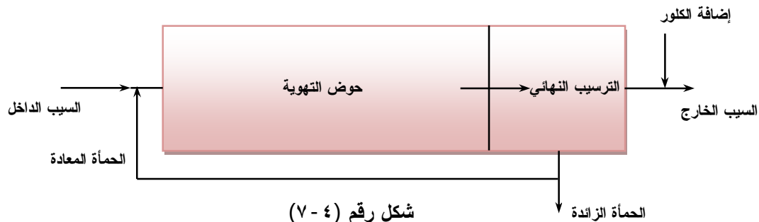
التهوية الممتدة (Extended Aeration)
