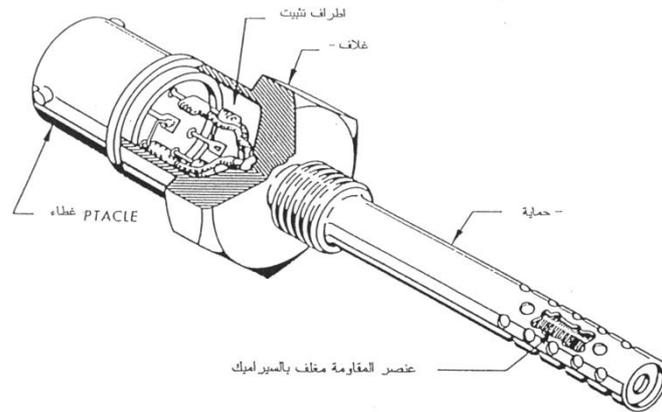
شكل (١٦) المقاومة الحرارية
