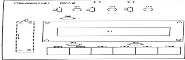
شكل (A) كارت الشاشة الخاصة بجهاز قياس الاكسجين المذاب
