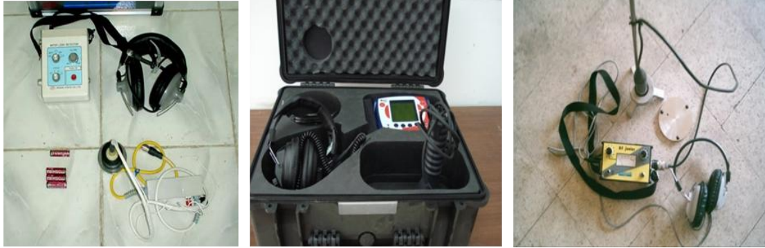
صورة رقم (١٤) توضح أنواع مختلفة من جهاز الميكرفون الأرضي
