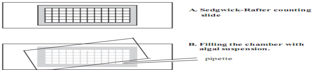
صورة رقم ( 21 ) : صورة توضح طريقة ملئ شريحة عدّ الطحالب سيدويك رافتر Sedgwick – Rafter
